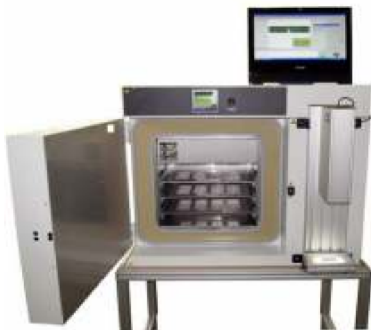
Komora termiczna wraz z pojemnikiem wysuwającym oraz przyrządem do kontroli optycznej wymiarów próbek
