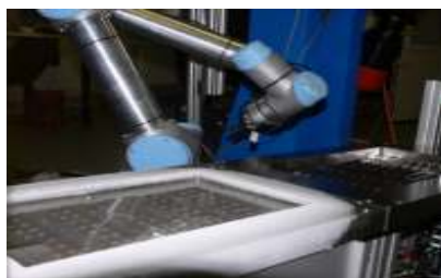
Komora zewnętrzna ze zbiornikiem oraz ramieniem robota do automatycznego podawania próbek.
